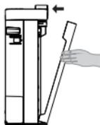
\*Das Gerät läuft nicht mit geöffneter Abdeckung
